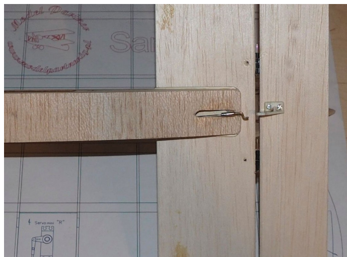
Napęd steru wysokości wyprowadzamy na końcu spodniej części kadłuba, wykonując w poszczególnych otwór
