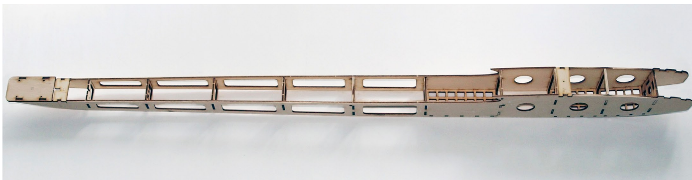
Kadłub przygotowany do wklejania statecznika pionowego oraz przyklejenia poszycia górnego i dolnego
