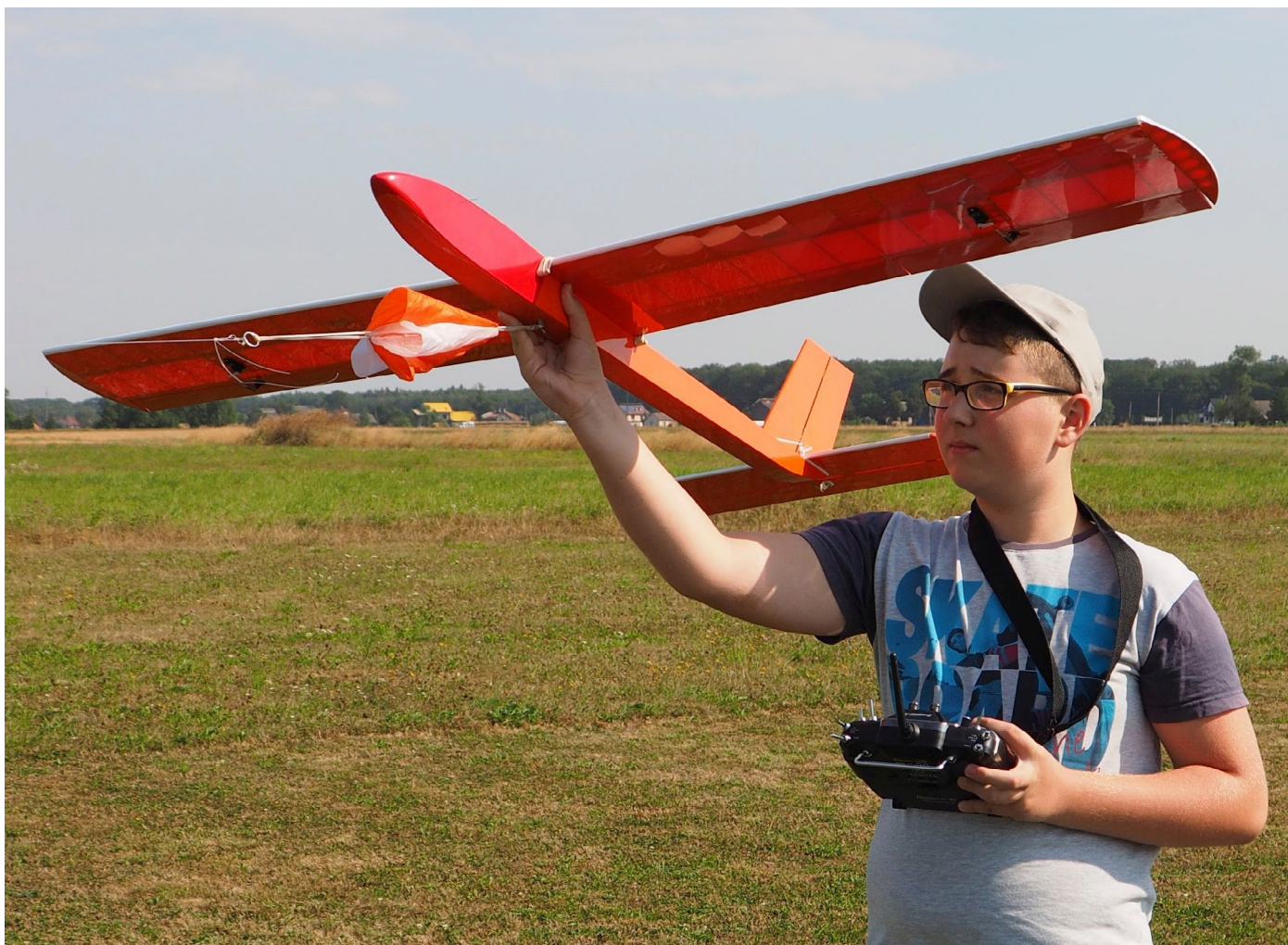
Mateusz Pichór (13 lat) z modelarni w Zabierzowie Bocheńskim z modelem szybowca „Sara” podpiętym do holu gumowego (10 metrów gumy/rurki o średnicy 8 mm i 50 metrów żyłki o średnicy 0,8 mm)
